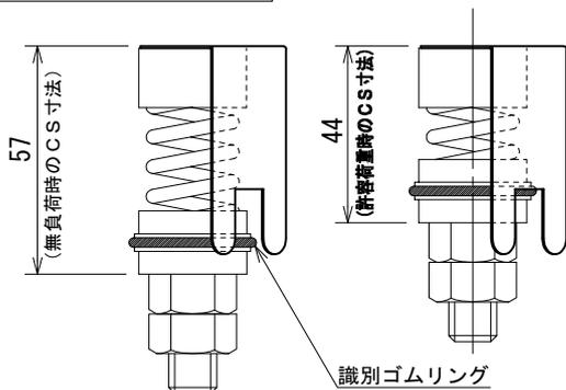
※識別ゴムリングが撓み確認ゲージのスリットから完全に隠れてしまった場合は荷重オーバーの状態。
