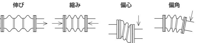
4) 製品が変位した時、周囲の構造物や機器（特に鋭利な角）に接触しないよう離隔をとって取付けてください。
