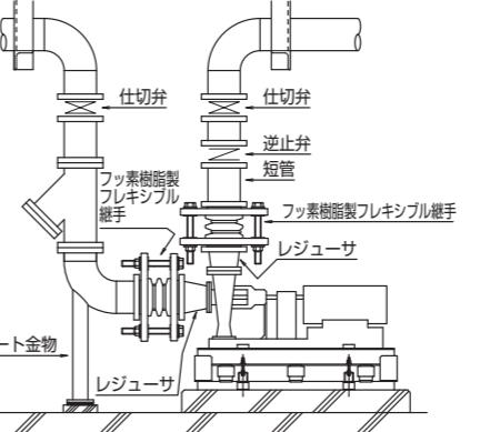
7) 取付け後、その付近で溶接・溶断を行う場合は、製品に火花が掛からないよう、保護用のカバーなどを被せてください。また溶接・溶断の熱が伝わる恐れのある場合には、製品を外すなどの処置をしてください。
