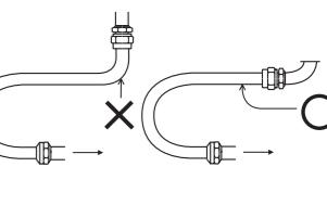
③ フレキシブルホース取付け時、ねじれが加わらないようご注意ください。繰返し変位を受けるような場合は、変位の方向と製品の曲げが同一平面になるように配慮し、ねじれを避けてください。（ねじれた状態で取付けられ内圧が加わると、ワイヤブレードが破断してフッ素樹脂チューブが緩み、漏れの原因となります。）
