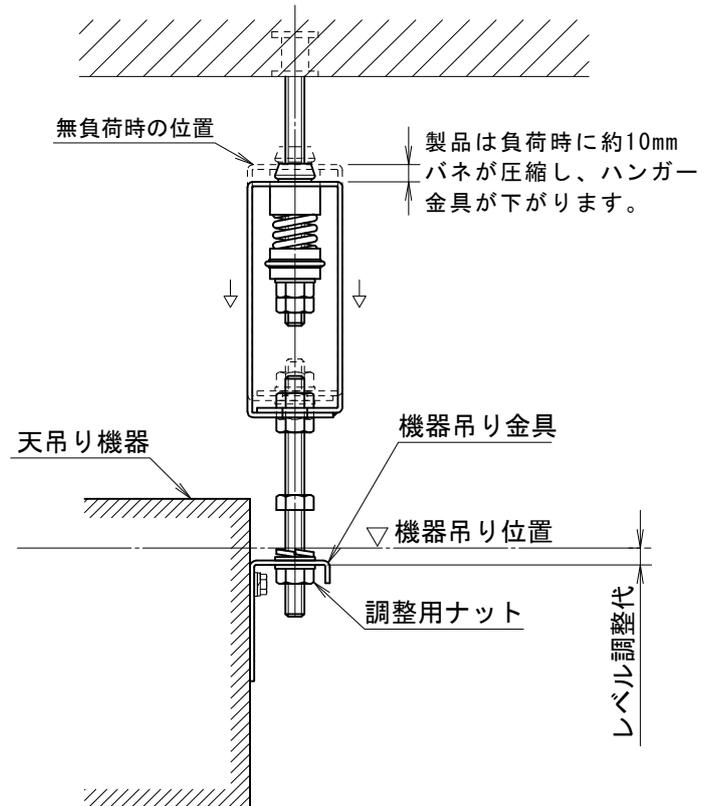
(3) 機器の吊り位置にレベル調整後、ナットを締め付けて施工完了。
