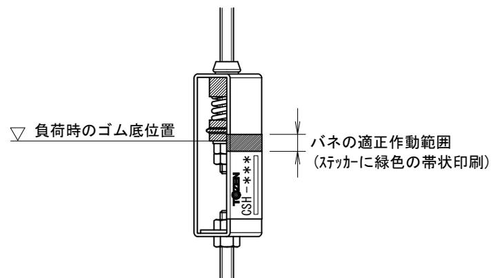
※適正作動範囲より上側にゴム底位置がある場合は防振材の許容荷重を超えているので許容荷重の大きな型番製品に取替えてください。
