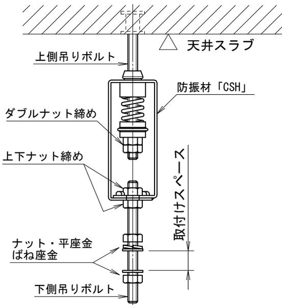
(2) 機器を吊りボルトに取付け、レベル調整を行う。
